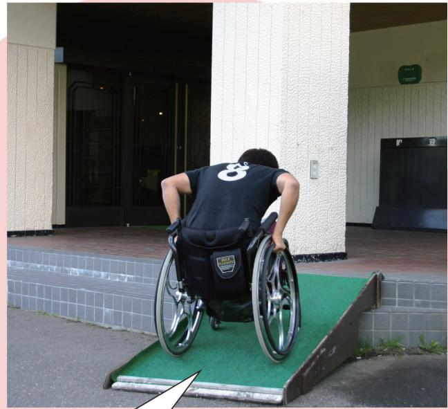
出入り口の段差に着脱式簡易スロープを設置して車いすの乗降をサポートします。スロープがなくても「スタッフがお手伝いします。」も気持ちよいサービスです。
